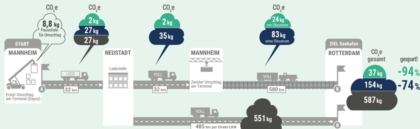
Das Rechenbeispiel zeigt den CO<sub>2</sub>e-Verbrauch beim Transport eines Containers von Mannheim nach Rotterdam. Statt der Bahn mit Ökostrom, kann der Hauptlauf auch mit dem E-Binnenschiff erfolgen.
